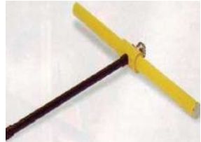
شكل رقم (١١) مثقاب يدوي (Increment borer) يستخدم لعمل ثقوب في جذع النخلة
