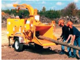
شكل رقم (١٠) أجهزة حديثة لتقطيع وطمحن جذوع الأشجار المصابة
