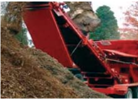
شكل رقم (٢) آلات حديثة لتقطيع وطحن جذوع النخيل واستخدامها كسماد عضوي
